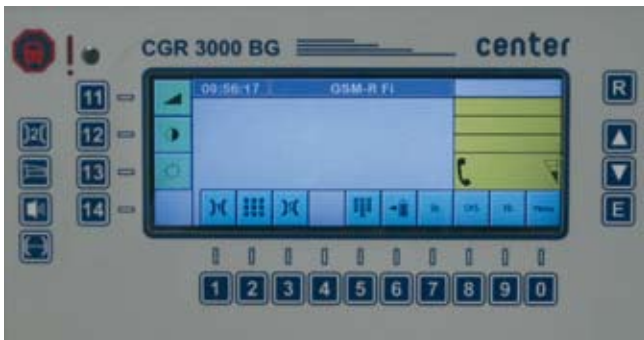
Ohjaamoradion käyttöpaneeli (Center Systems).
